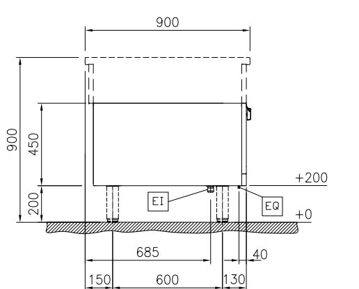
EI = Conexión eléctrica (energía)
